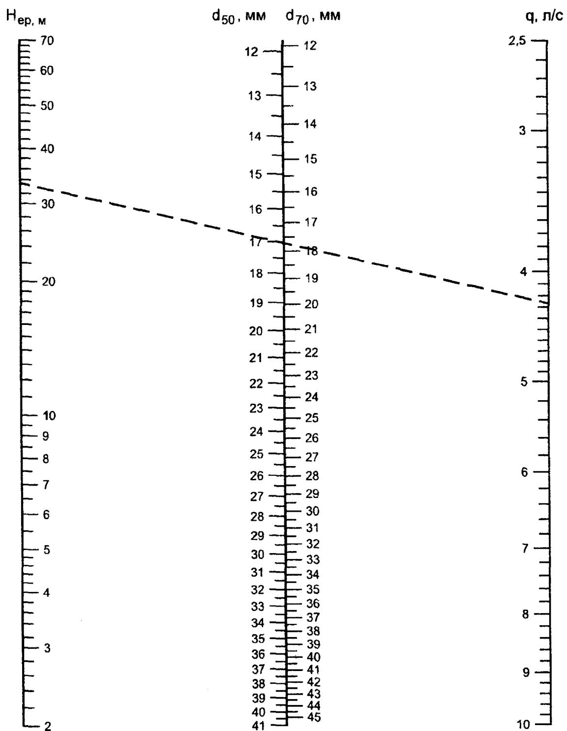
$d_{50}, d_{70}$  - диаметры отверстий диафрагм, устанавливаемых
